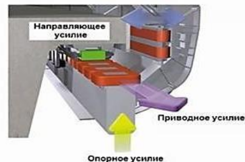
Магнитолевитационная транспортная система (МЛТС): отсутствие вращающихся частей и силы трения
